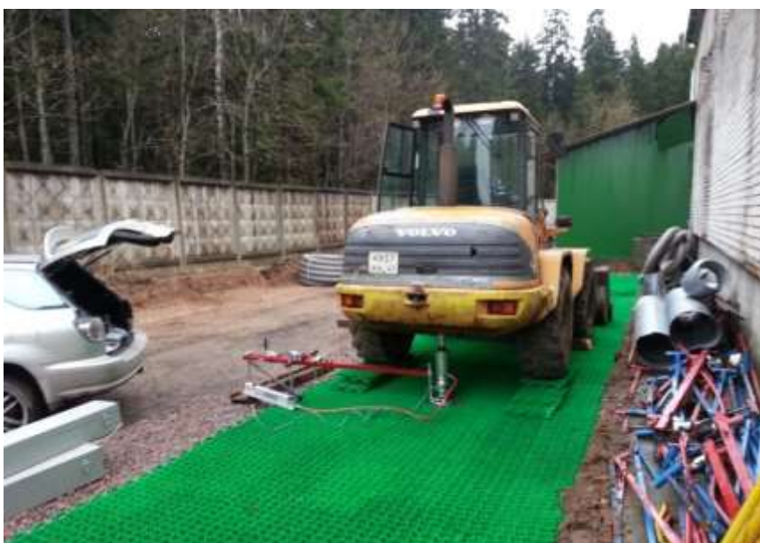
Рис. 3 – Штамповые испытания на производственной базе ГК «МИАКОМ»
