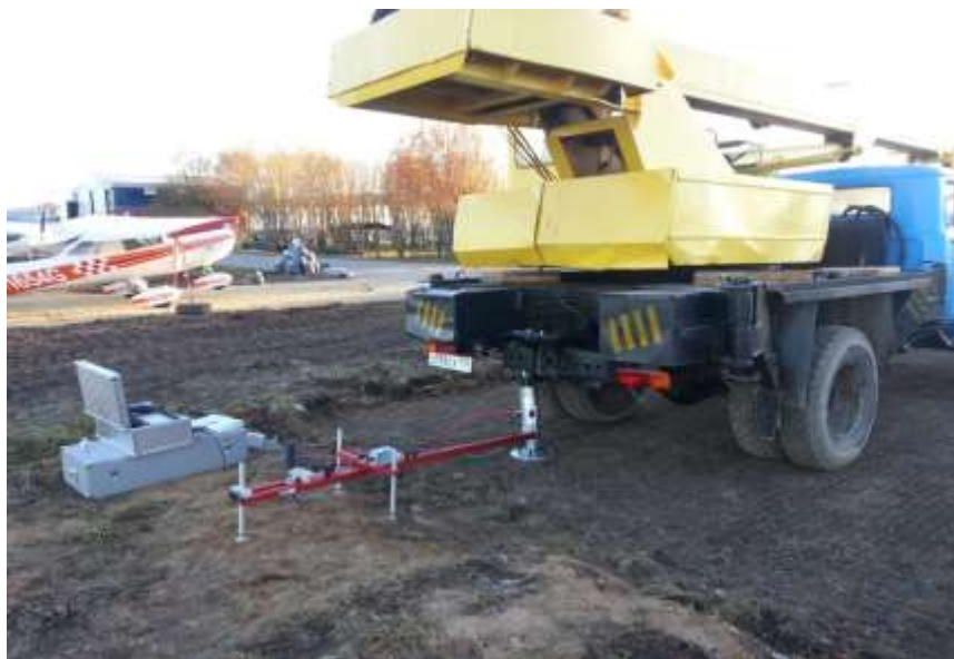
Рис. 2 – Штамповые испытания на аэродроме «Гостилицы»
