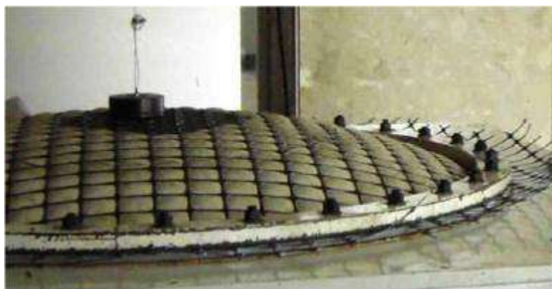
Рис. 4 Испытание на мультиосевое растяжение
