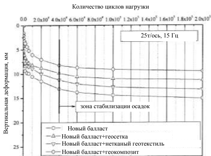
Рисунок 4 – Развитие осадок балластного слоя с применением геосинтетических материалов и без них [9]
