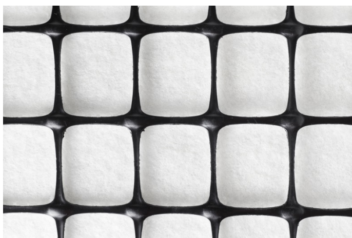
Рис. 6 Геокомпозит георешетки и нетканого геотекстиля
